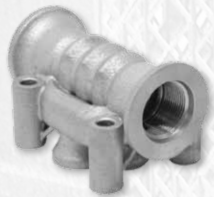
Blocchetto idraulico per impianti oleodinamici. Componente alleggerito del 50% e ridimensionato con software di ottimizzazione topologica (Acciaio Inox 316L e Alluminio AISI10Mg)
